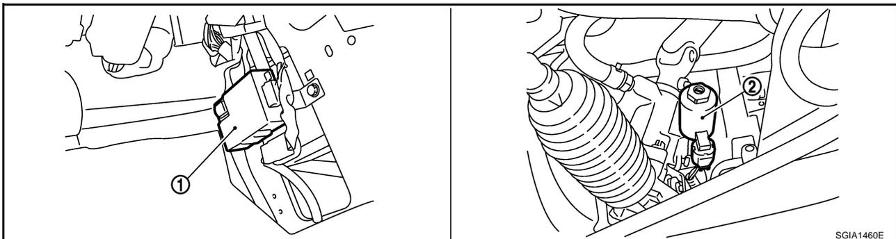
1. Boîtier de commande de direction assistée (arrière de la garniture de tablier latéral droit)
