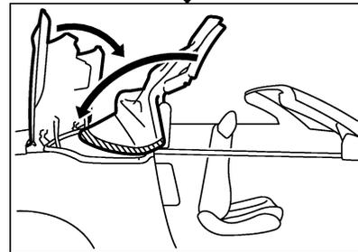
4. Le dossier de siège passager revient à sa position d'origine lorsque le 5ème arceau est fermé.
