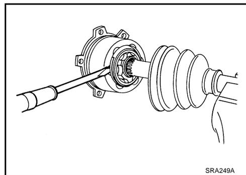
5. Déposer le jonc d'arrêt, puis déposer la cage à billes/la bille d'acier/la bague interne de l'ensemble de l'arbre.
