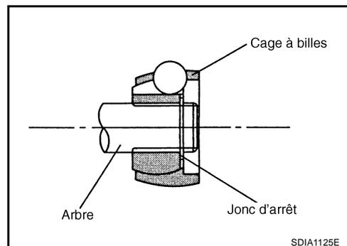
5. Insérer la quantité de graisse mentionnée ci-dessous (graisse d'origine NISSAN ou équivalente) dans le logement (point \*) et le reposer sur l'arbre.
