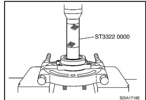
3. A l'aide d'un chasoir (SST) et d'un extracteur (outil adéquat), appuyer sur la bague interne du côté externe du roulement de roue pour le déposer du moyeu de roue.
