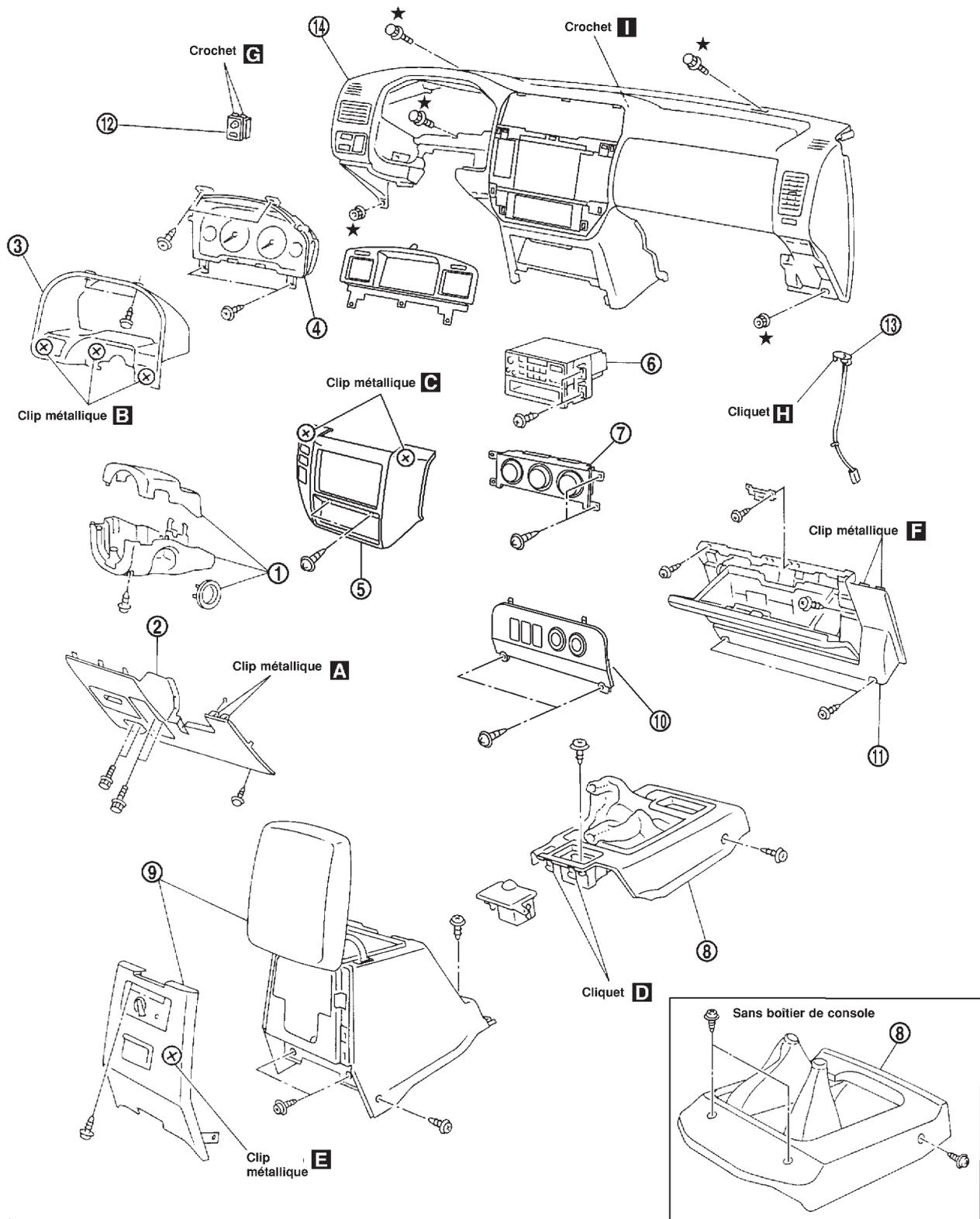
★ : Boulons et écrous de montage de l'ensemble tableau de bord
