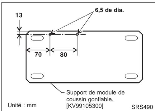
2. Fixer solidement le support de module de coussin gonflable [outil spécial : KV99105300] dans un étau.
