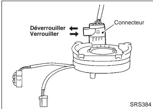
3. S'assurer que le câble spiralé est sur la position neutre. Pour obtenir la position neutre, le tourner d'environ 2,5 tours vers la gauche à partir de la position de butée droite. Aligner les deux repères (X).
