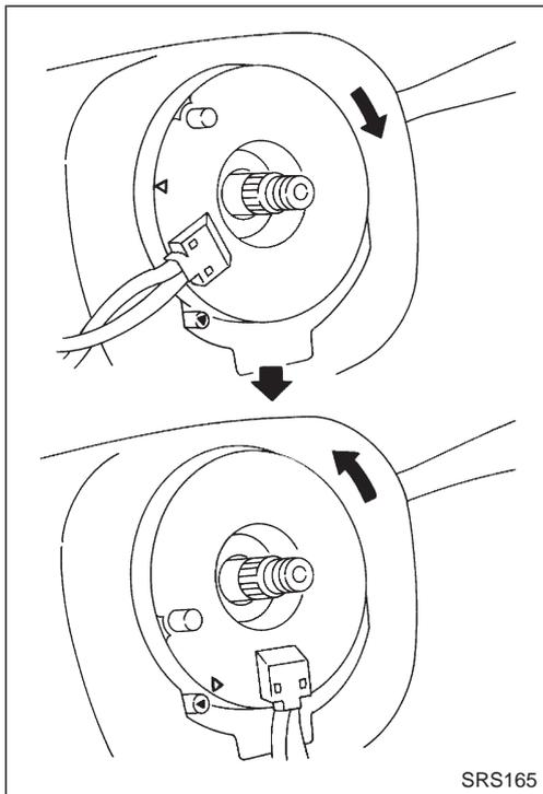
5. Reposer le volant de direction, en plaçant le guide d'axe de câble spiralé, et tirer le câble spiralé à travers.
