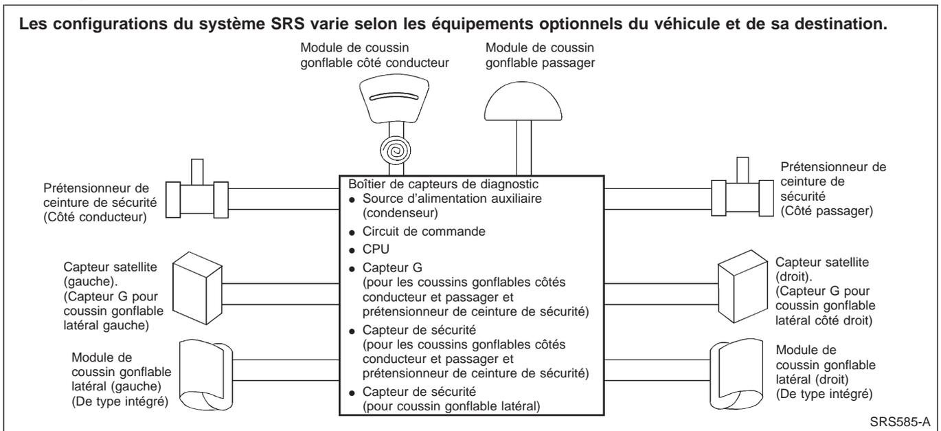
Les modes de collision pour lesquels les systèmes de retenue supplémentaires sont activés diffèrent selon les systèmes SRS. Par exemple, les modules de coussin gonflables conducteur et passager se déploieront lors d'une collision frontale, mais pas d'une collision latérale.
