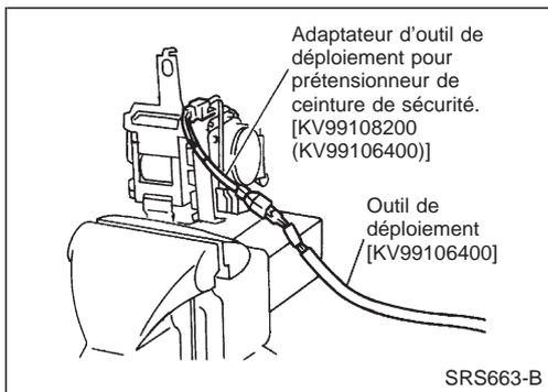
2. Brancher l'adaptateur de l'outil de déploiement [Outil spécial : KV99108200 (KV999R0020)] sur l'outil de déploiement [Outil spécial : KV99106400] et sur le connecteur du prétensionneur de ceinture de sécurité.
