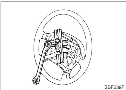
2. Déposer le couvercle du côté, la commande de direction ASCD et la commande de direction audio (uniquement sur les modèles pour le Moyen-Orient). A l'aide d'un EMBOUT TORX DE SECURITE (Taille T50), déposer les boulons spéciaux gauche et droit. Le module de coussin gonflable peut alors être déposé.
