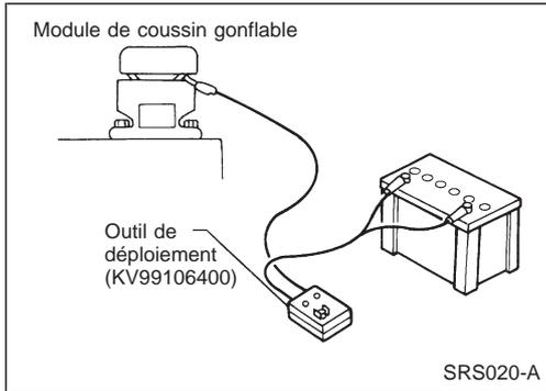
5. Brancher le clip rouge de l'outil de déploiement à la borne positive de batterie et le clip noir à la borne négative.
