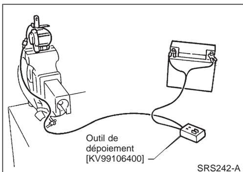
3. Brancher le clip rouge de l'outil de déploiement à la borne positive de batterie et le clip noir à la borne négative.
