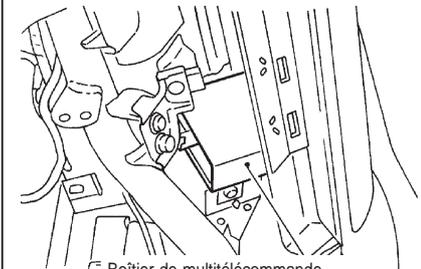
Boîtier de multitélcommande (M129, M133)
