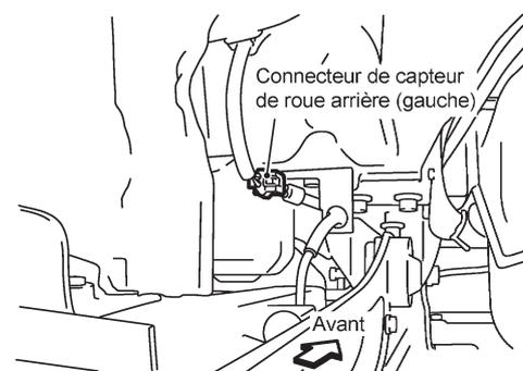
Connecteur de capteur de roue arrière (gauche)
