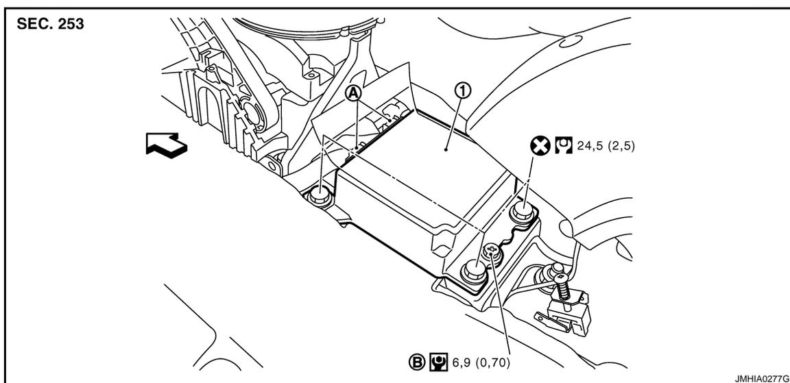
1. Boîtier de capteurs de diagnostic
