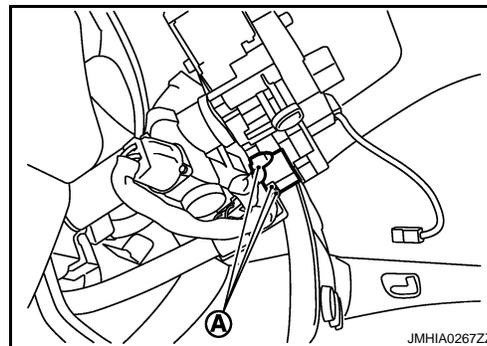
5. Déposer les vis de fixation de câble spiralé, et le cliquet.
