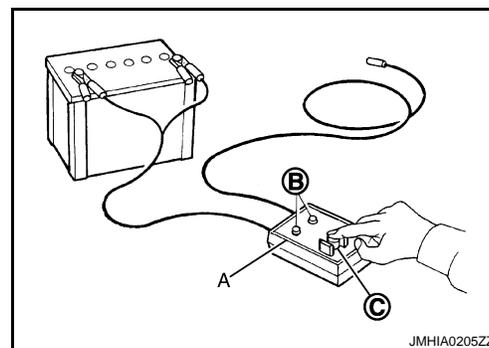
Tableau de fonctionnement des témoins de l'outil de déploiement d'airbag (batterie branchée)
