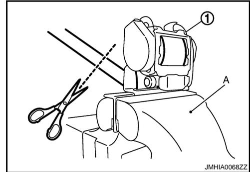
2. Connecter l'outil de déploiement (outil spécial : KV99106400) (A) et le connecteur orange de l'adaptateur d'outil de déploiement (SST : KV99110500) (B) au prétensionneur de ceinture de sécurité avant (1).
