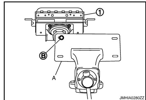
3. Connecter l'outil de déploiement (outil spécial : KV99106400) (A) et le connecteur orange de l'adaptateur d'outil de déploiement (SST : KV99110500) (B) au connecteur du module d'airbag côté passager avant (1).
