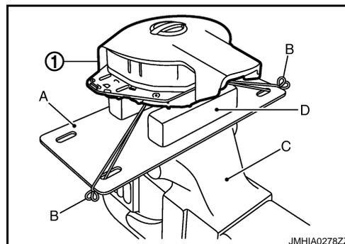
4. Raccorder l'adaptateur de l'outil de déploiement (outil spécial : KV99110500) (B) au module d'airbag (1) et au connecteur de l'outil de déploiement (SST : KV99106400) (A).
