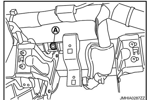
3. Débrancher le connecteur de module d'airbag côté passager (A).
