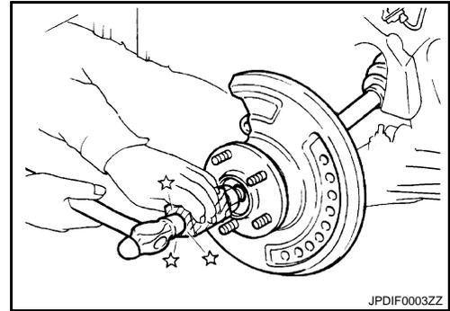
7. Déposer l'ensemble de moyeu et de roulement de roue.
