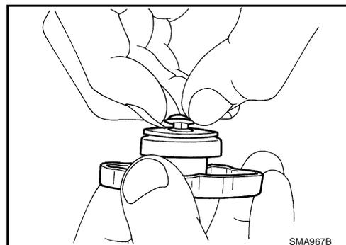
2. Contrôler la pression de décharge du bouchon de radiateur.
