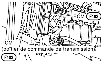
Vue avec partie inférieure du tableau de bord déposée
