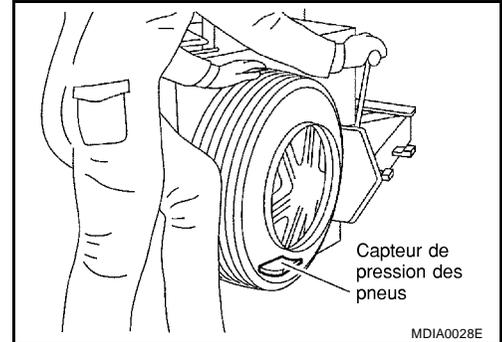
3. Tourner le pneu de façon que le trou pour la valve se situe en bas et le faire rebondir afin que le capteur vienne près du trou pour la valve. Soulever prudemment le pneu pour le poser sur un plateau tournant et positionner le trou pour la valve (et l'émetteur) à 270 degrés de la tête de montage/démontage.
