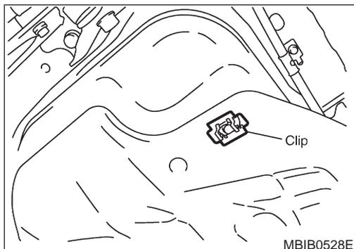
10. Abaisser le réservoir de 70 à 80 mm, déposer les écrous et les clips tout en maintenant la protection et déposer la protection.
