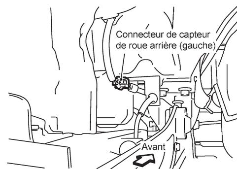
Connecteur de capteur de roue arrière (gauche)
