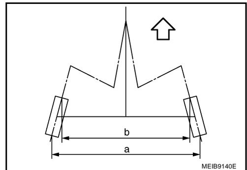
5. Pousser lentement le véhicule vers l'avant de façon à faire tourner les roues de 180 degrés (1/2 tour).
