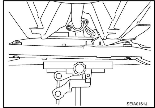
10. Déposer le boulon de stabilisateur et déposer le collier et la bague.
