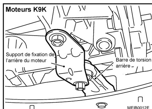
6. Déposer le boulon du côté arrière de la pièce de maintien du longeron de suspension.
