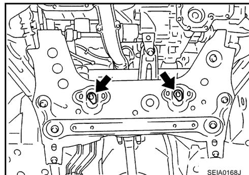
5. Déposer la barre de torsion arrière de la boîte-pont. Pour les modèles avec moteur CR, se reporter à [EM-76, "MOTEUR"](#). Pour les modèles avec moteur HR, se reporter à [EM-200, "ENSEMBLE DU MOTEUR"](#). Pour les modèles avec moteur K9K, se reporter à [EM-311, "ENSEMBLE DU MOTEUR"](#).
