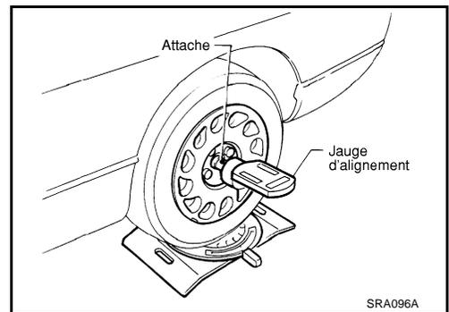
2. Si les angles d'inclinaison de carrossage, de chasse et du pivot de fusée ne sont pas conformes à la spécification, inspecter les pièces de la suspension avant. Remplacer les pièces endommagées ou usées.
