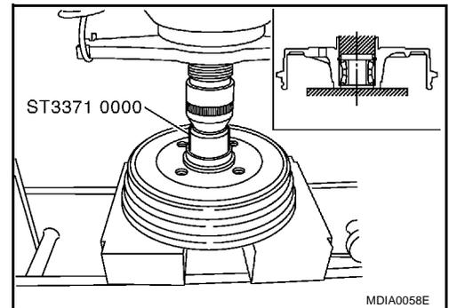
3. Enfoncer le rotor de capteur sur le tambour de frein avec un chassoir (outil spécial).
