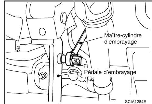
3. Déposer la goupille d'arrêt du maître-cylindre et séparer le tuyau d'embrayage.
