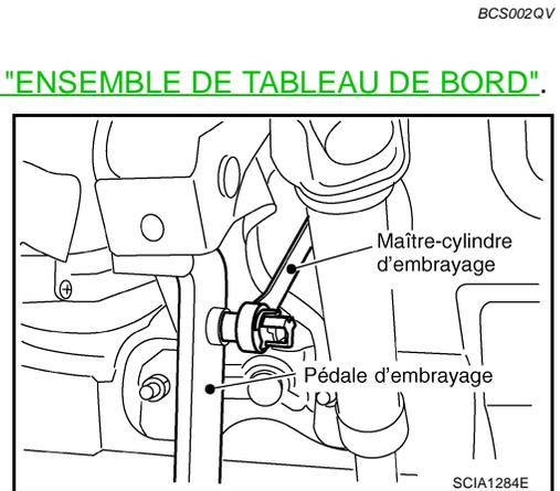
5. Retirer les écrous (3), puis déposer l'ensemble de la pédale d'embrayage.
