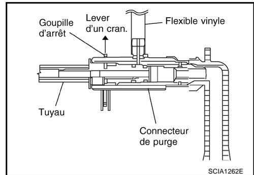
5. Faire coulisser le tuyau de 5 mm dans la direction indiquée par la flèche et vidanger le liquide d'embrayage.
