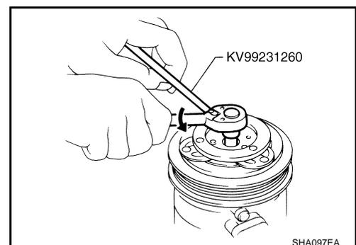
3. Déposer le plateau d'entraînement en utilisant l'extracteur de plateaux d'entraînement.
