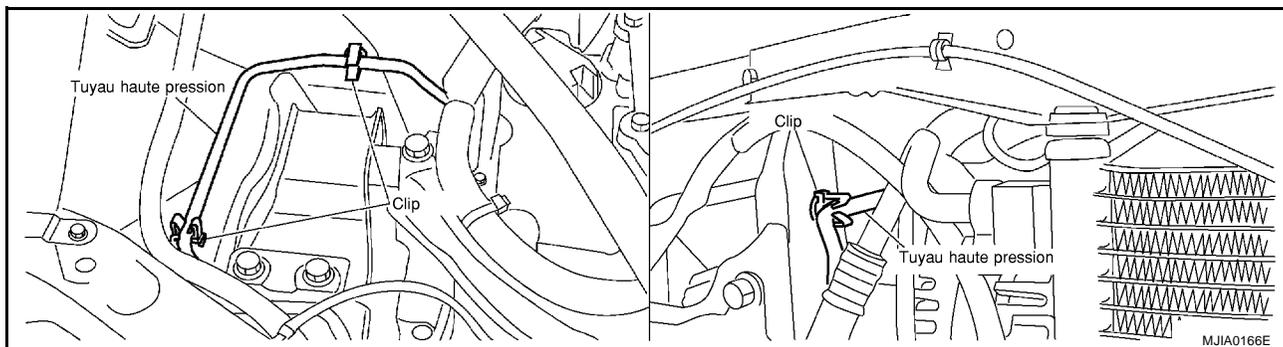
6. Déposer les boulons de fixation du tuyau haute pression et déposer ensuite la tuyau haute pression.
