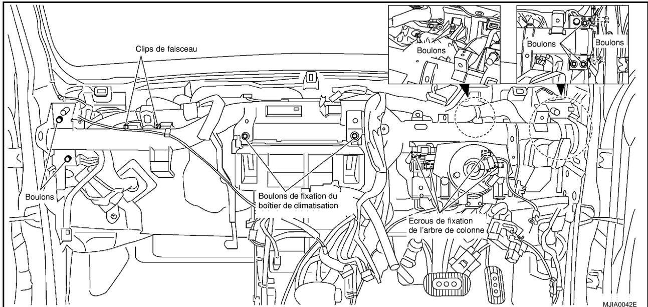
6. Déposer l'élément de direction et déposer ensuite le conduit du ventilateur latéral (côté droit).
