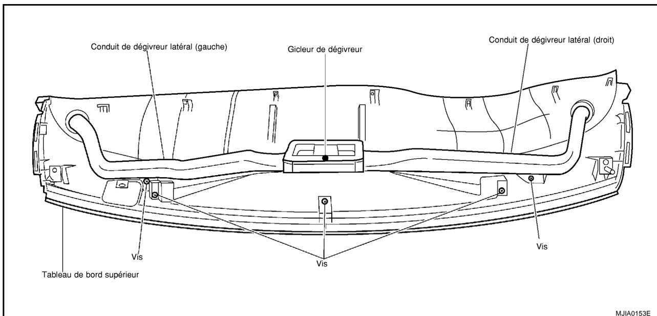
2. Déposer les conduits latéraux de dégivreur (gauche/droite) et les gicleurs de dégivreur du tableau de bord supérieur.
