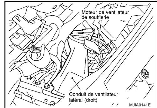
3. Débrancher le flexible de refroidissement et déposer le moteur de ventilateur de soufflerie.
