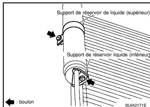
5. Soulever le support du réservoir de liquide et le déposer de la partie saillante du condenseur.
