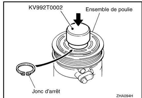
4. Reposer la plaque d'entraînement sur le semi-arbre avec la/les rondelle(s) d'origine. Appuyer sur le disque d'embrayage à la main.
