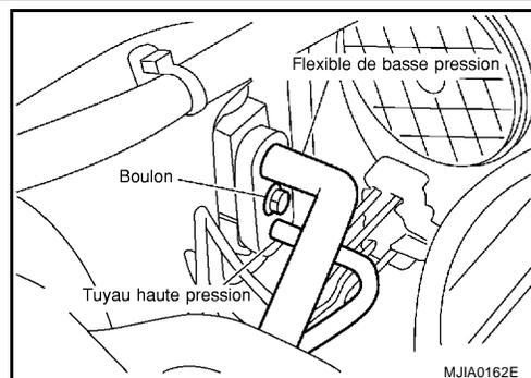
6. Déposer les boulons de fixation du flexible de basse pression (du côté compresseur) et déposer ensuite le flexible de basse pression.
