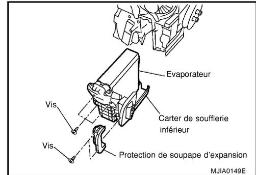
5. Faire glisser l'évaporateur et le boîtier de la soufflerie de porte vers le bas et déposer l'amplificateur thermique.
