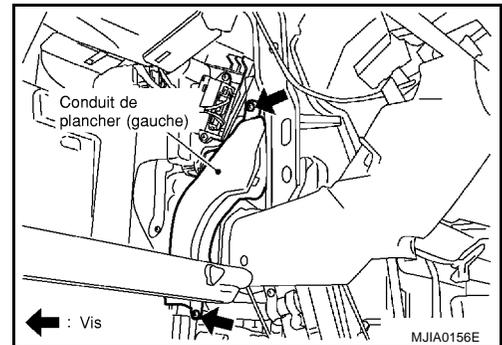
3. Déposer le support inférieur du tableau de bord. Se reporter à [IP-9, "D. Tiroir inférieur de tableau de bord"](#).
