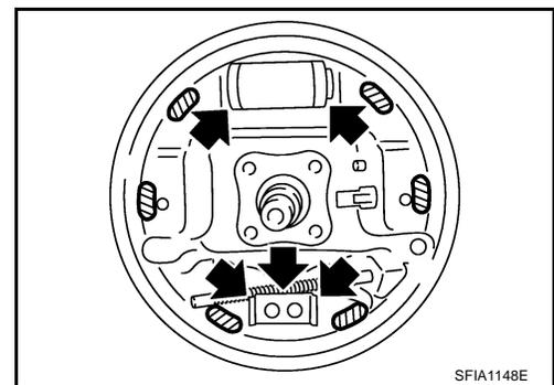
2. Raccourcir le dispositif de réglage en le faisant tourner.
