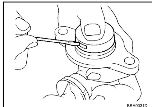
2. Déposer le réservoir et sa vis de fixation du corps du cylindre.
