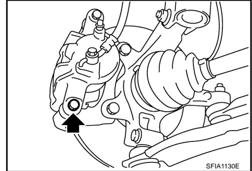
4. Accrocher le corps de cylindre à un câble et déposer les plaquettes et les retenues de plaquettes du membre de torsion.
