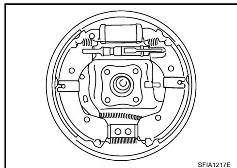
7. Lors de la pose d'un nouveau cylindre de roue ou d'un cylindre de roue réparé, en purger l'air. Se reporter à [BR-10, "Purge du circuit de freinage"](#).
