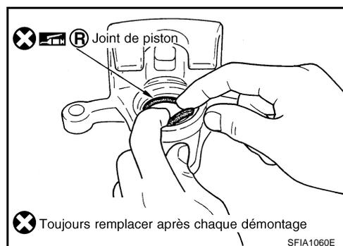
2. Appliquer le liquide de frein, le lubrifiant pour caoutchouc NISSAN (KRE1200030) ou un lubrifiant équivalent sur le soufflet du piston, couvrir l'extrémité du piston avec le soufflet sur le côté du cylindre et s'assurer qu'il se trouve dans la rainure de la cavité du corps du cylindre.
