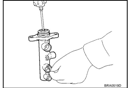
4. En maintenant le piston avec la coupelle de butée, pousser cette coupelle totalement jusqu'à ce que les pattes soient engagées avec la rainure sur le corps du cylindre à connecter.
