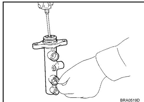
6. Frapper la bride contre un bloc souple tel que du bois et tirer soigneusement l'ensemble de piston secondaire tout droit pour éviter d'endommager la paroi interne du cylindre.
