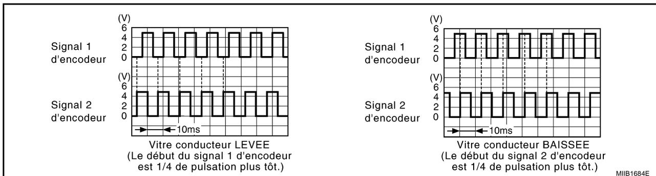
Si la vitre de porte subie une certaine résistance en raison de l'obstruction par un corps étranger durant l'opération de fermeture suivante.
