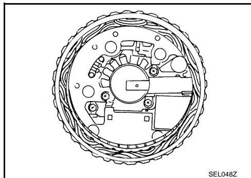
2. Pousser les balais vers le haut avec les doigts et les reposer sur le rotor.
