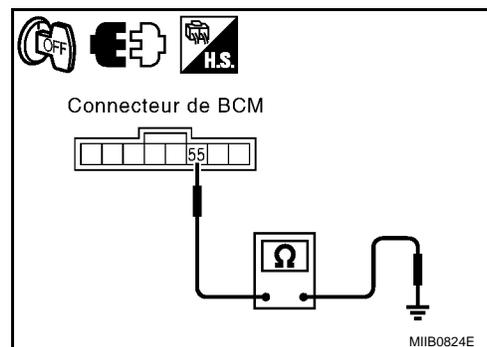
Vérification de l'alimentation électrique et du circuit de mise à la masse de l'ensemble de moteur de toit ouvrant
