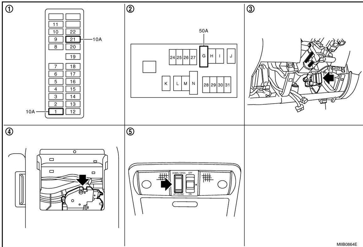
1. Disposition des fusibles dans la boîte à fusibles (B/J)
