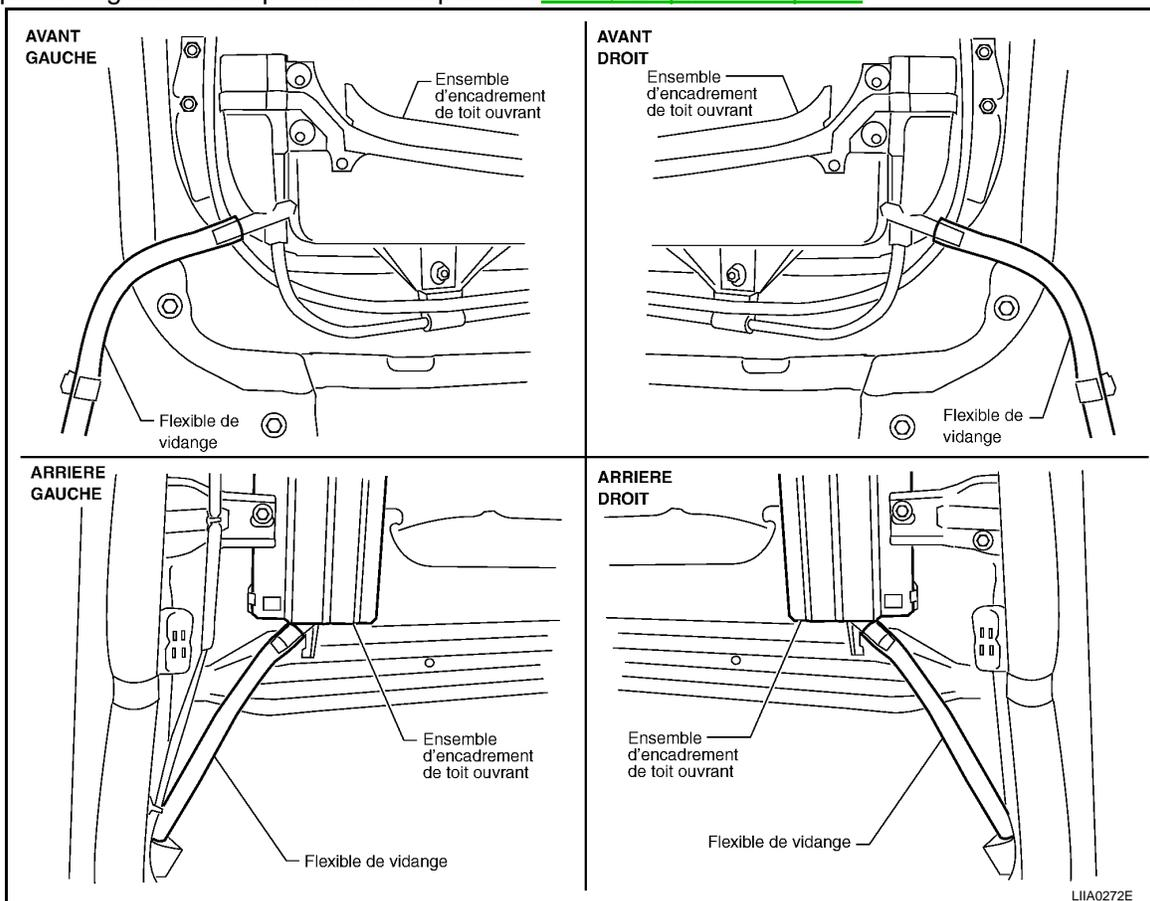
2. Vérifier visuellement si les flexibles d'écoulement sont bien raccordés et s'ils ne sont pas endommagés, fissurés ou détériorés.
