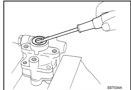
9. Déposer le boulon à œil, puis déposer le joint et la rondelle en cuivre. Extraire ensuite la soupape de commande de volume et le ressort de l'ensemble de corps.
