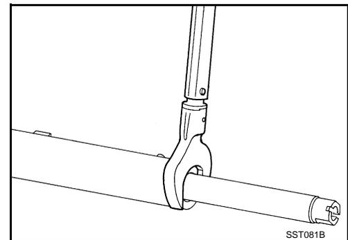
6. Plier l'ensemble de carter d'engrenage en un point à l'aide d'un chasse-goupille comme illustré, afin d'empêcher le desserrage de l'ensemble de couvercle latéral une fois serré.
