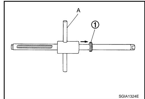
4. Appliquer de la graisse recommandée sur le joint d'huile de crémaillère, puis poser le joint d'huile de crémaillère en suivant la procédure ci-après. Monter ensuite l'ensemble de crémaillère sur l'ensemble de carter d'engrenage.
