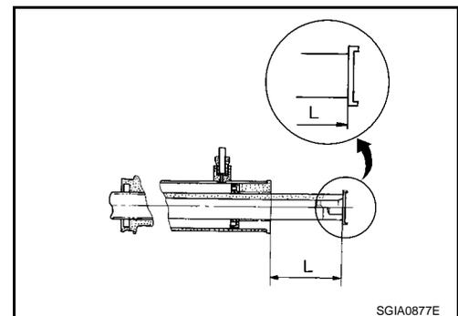
10. Enduire le filetage de produit de blocage de filetage recommandé (2 tours de filetage), puis visser la vis de réglage jusqu'à obtenir la hauteur "H" à partir de l'ensemble de carter d'engrenage, mesurée préalablement au démontage.
