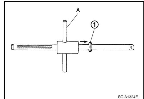
4. Appliquer de la graisse recommandée sur le joint d'huile de crémaillère, puis poser le joint d'huile de crémaillère en suivant la procédure ci-après. Monter ensuite l'ensemble de crémaillère sur l'ensemble de carter d'engrenage.
