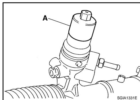
4. Déposer le joint torique A à l'aide d'un tournevis à lame plate, puis extraire le couvercle arrière.
