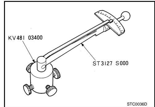
14. Mesurer le couple de rotation du pignon à l'aide de l'adaptateur et de la jauge de précharge (outils spéciaux) et s'assurer que la valeur mesurée est conforme aux spécifications. Régler à nouveau si la valeur est hors spécification. Remplacer l'ensemble de mécanisme de direction si la valeur est toujours hors spécification au terme du nouveau réglage ou si le couple de rotation de la vis de réglage est inférieur ou égal à 5 N·m (0,51 kg·m).
