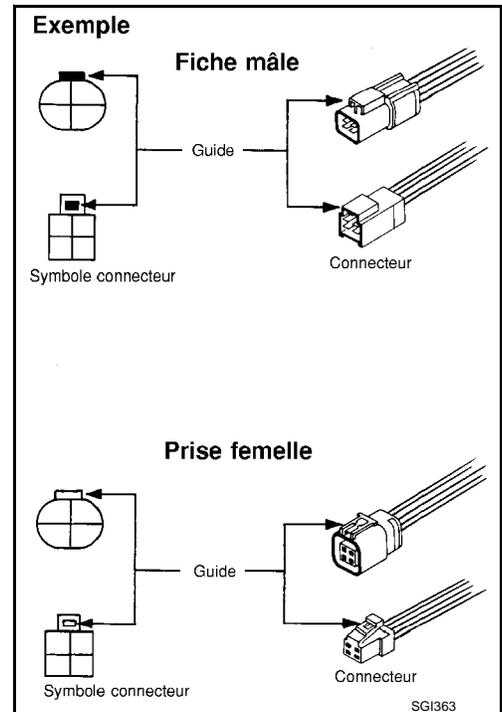
ECHANTILLON/SCHEMA DE CABLAGE - EXAMPL -
