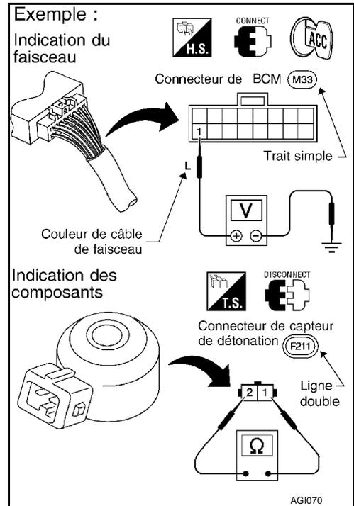
TYPE 2 : La couleur de câble de faisceau et le numéro de connecteur sont indiqués dans le texte
