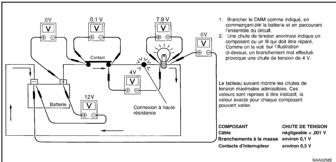
Test de circuit des boîtiers de commande
