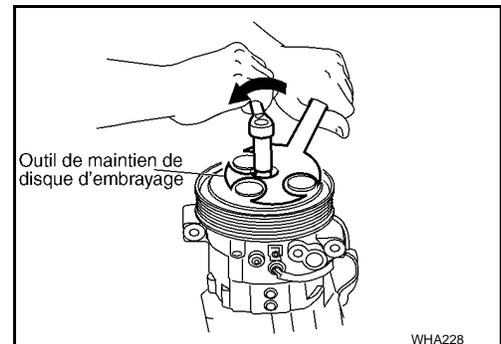
4. Déposer le jonc d'arrêt avec des pinces pour jonc d'arrêt externes ou autre outil adéquat.
