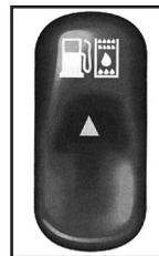
Le séparateur d'eau élimine l'eau contenue dans les carburants dont la teneur en eau est élevée. Le séparateur est intégré au filtre à carburant. Le voyant correspondant se trouve sur la console centrale.
