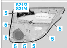
5 Agrafes 6 Câble Bowden 7 Coupleur S21/4 Contacteur lève-glace ARD N69/3 Calculateur commande porte ARG S21/3 Contacteur lève-glace ARG N69/4 Calculateur commande porte ARD
