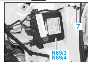
5 Agrafes 6 Câble Bowden 7 Coupleur S21/4 Contacteur lève-glace ARD N69/3 Calculateur commande porte ARG S21/3 Contacteur lève-glace ARG N69/4 Calculateur commande porte ARD
