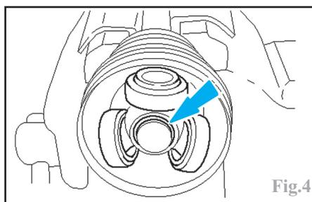
À l'aide d'un extracteur approprié, extraire le tripode de l'arbre et récupérer le soufflet en le faisant glisser sur l'arbre, si il est réutilisé.
