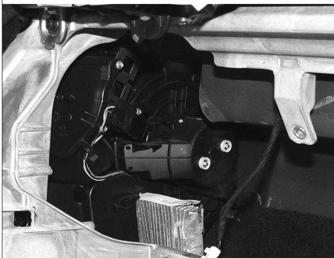
Résistance du motoventilateur mesurée sur l'élément : environ 1 Ω.
