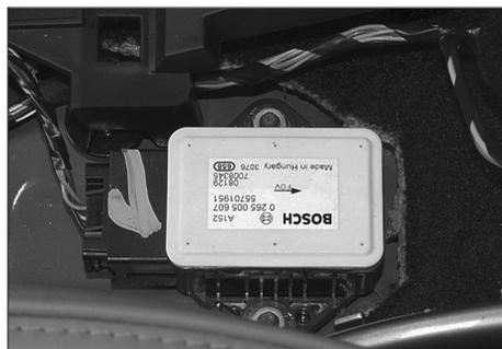
CAPTEUR GYROMÈTRE ACCÉLÉROMÈTRE
