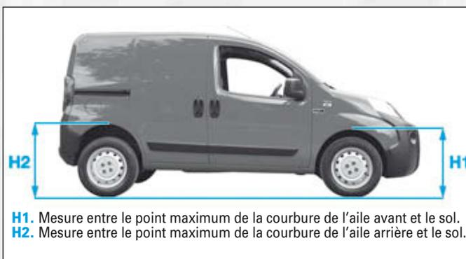
H1. Mesure entre le point maximum de la courbure de l'aile avant et le sol.
