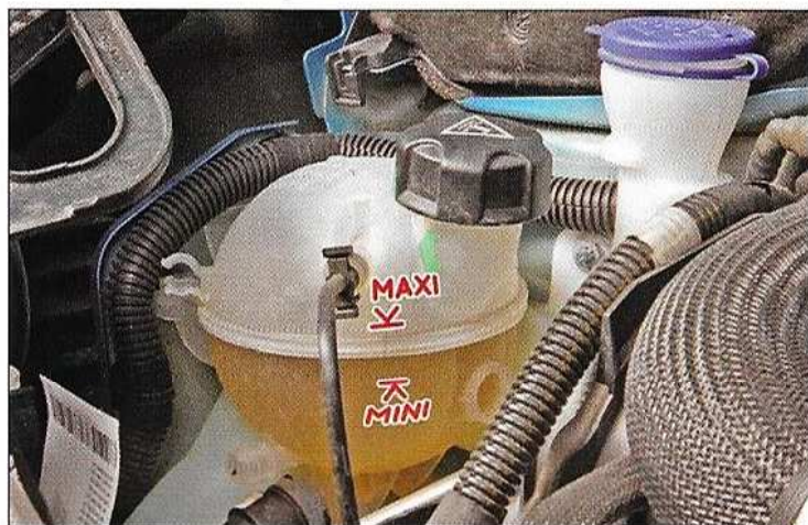
CONTRÔLE DU NIVEAU DE LIQUIDE DE REFROIDISSEMENT
