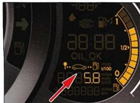
IMPLANTATION DE L'AFFICHAGE DES INFORMATIONS DE L'ORDINATEUR DE BORD SUR LE COMBINÉ D'INSTRUMENTS
