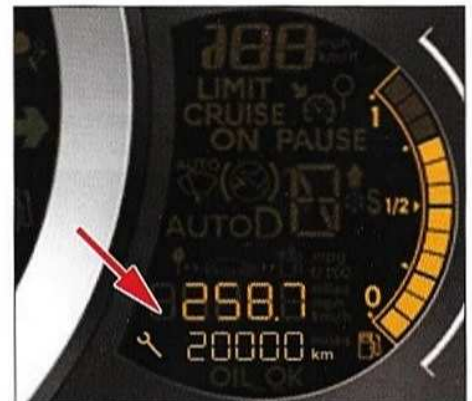
IMPLANTATION DE L'INDICATEUR DE MAINTENANCE
