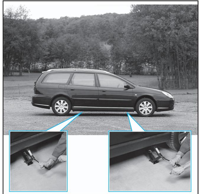
Prendre soin de caler la roue opposée à celle qui doit être levée, en utilisant une cale, puis serrer le frein de stationnement et engager si nécessaire la première vitesse ou la marche arrière, contact coupé.
