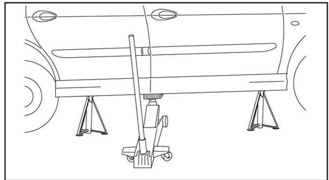
Pour assurer la stabilité du véhicule, placer des chandelles de sécurité sous les points de levage destinés à recevoir le cric de bord.
