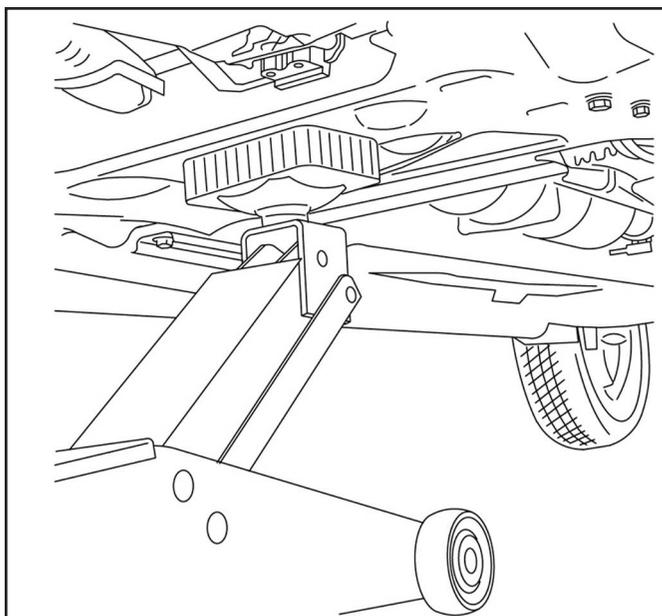
Pour assurer la stabilité du véhicule, placer des chandelles de sécurité de chaque côté du berceau moteur.
