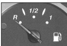
Dès que le témoin de mini s'allume de façon permanente, sur le plat, la réserve est d'environ 7 litres.
