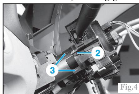
Débrancher les connecteurs et déposer le contacteur tournant.
