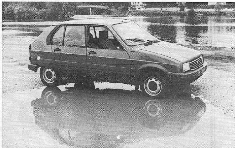
La Visa Diesel se distingue des modèles essence par ses jantes à quatre fixations et ses extensions d'ailes avant.
