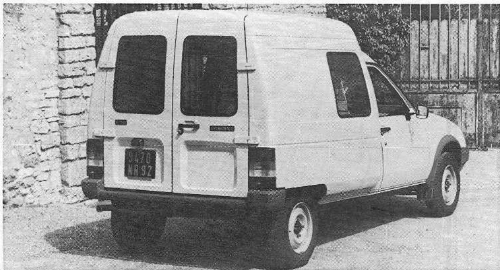
Présenté avec une porte arrière unique, le C 15 Diesel existe depuis 1986 pourvu de 2 battants. Pour les carrossiers, un châssis cabine peut également être fourni.
