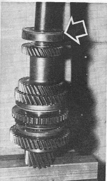
Repose du roulement d'arbre secondaire Flèche : gorge du circlip
