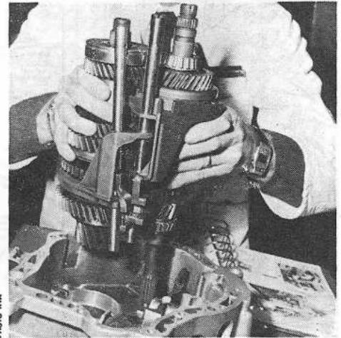
Mise en place de la pignonnerie dans le carter
