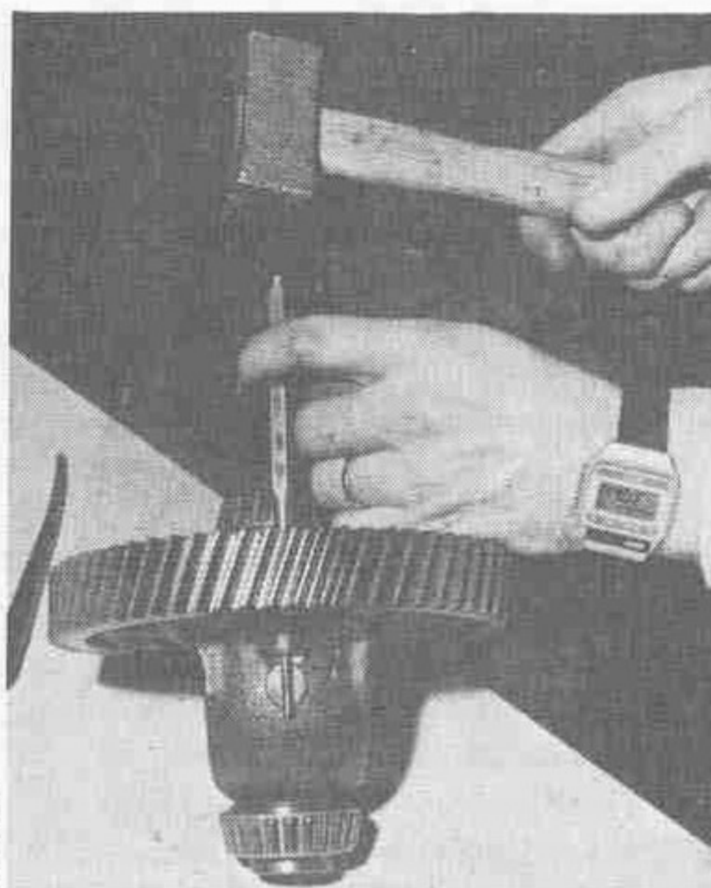
Dépose de la goupille d'arrêt d'axe de satellites
