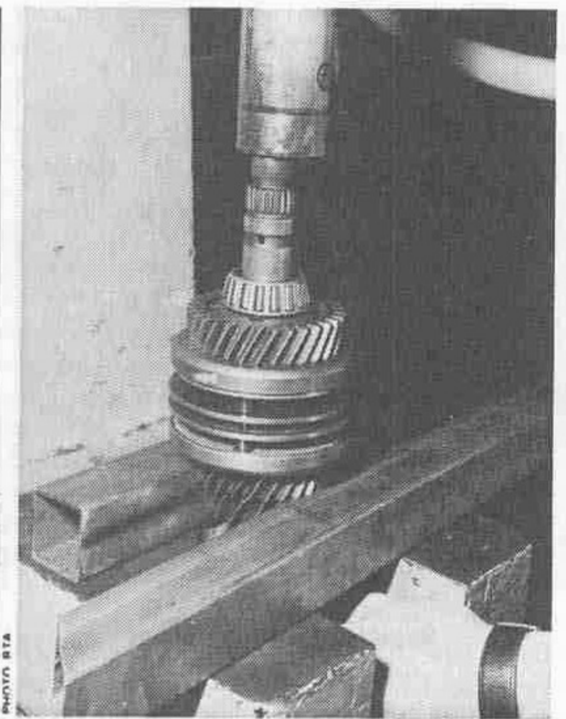
Dépose à la presse de l'ensemble roulement-pignon baladeur de 4°
