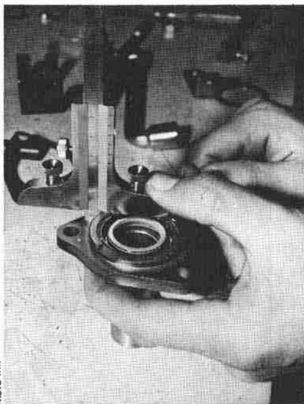
Mesure de l'épaulement du guide de butée
