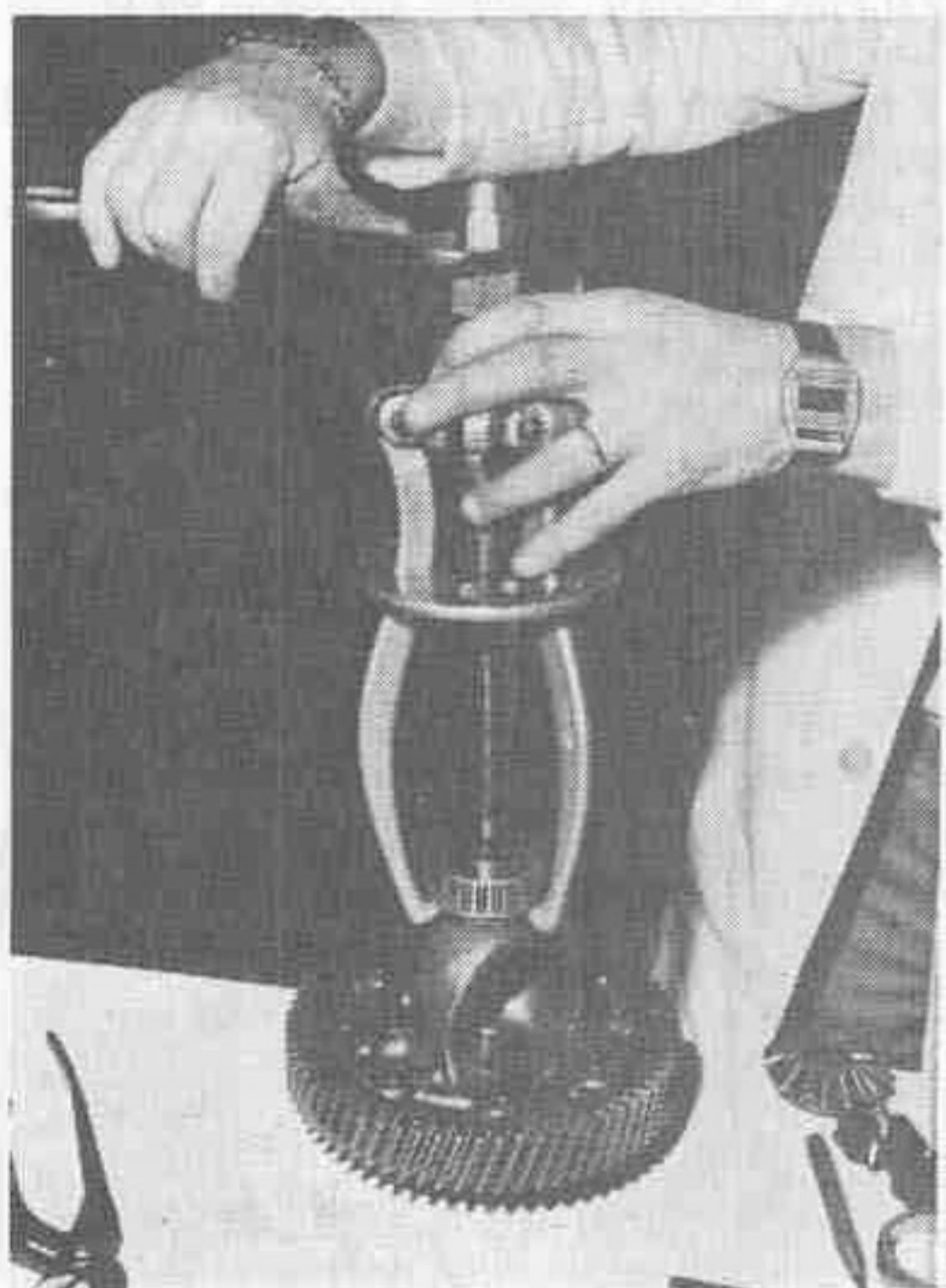
Extraction des roulements de différentiel
