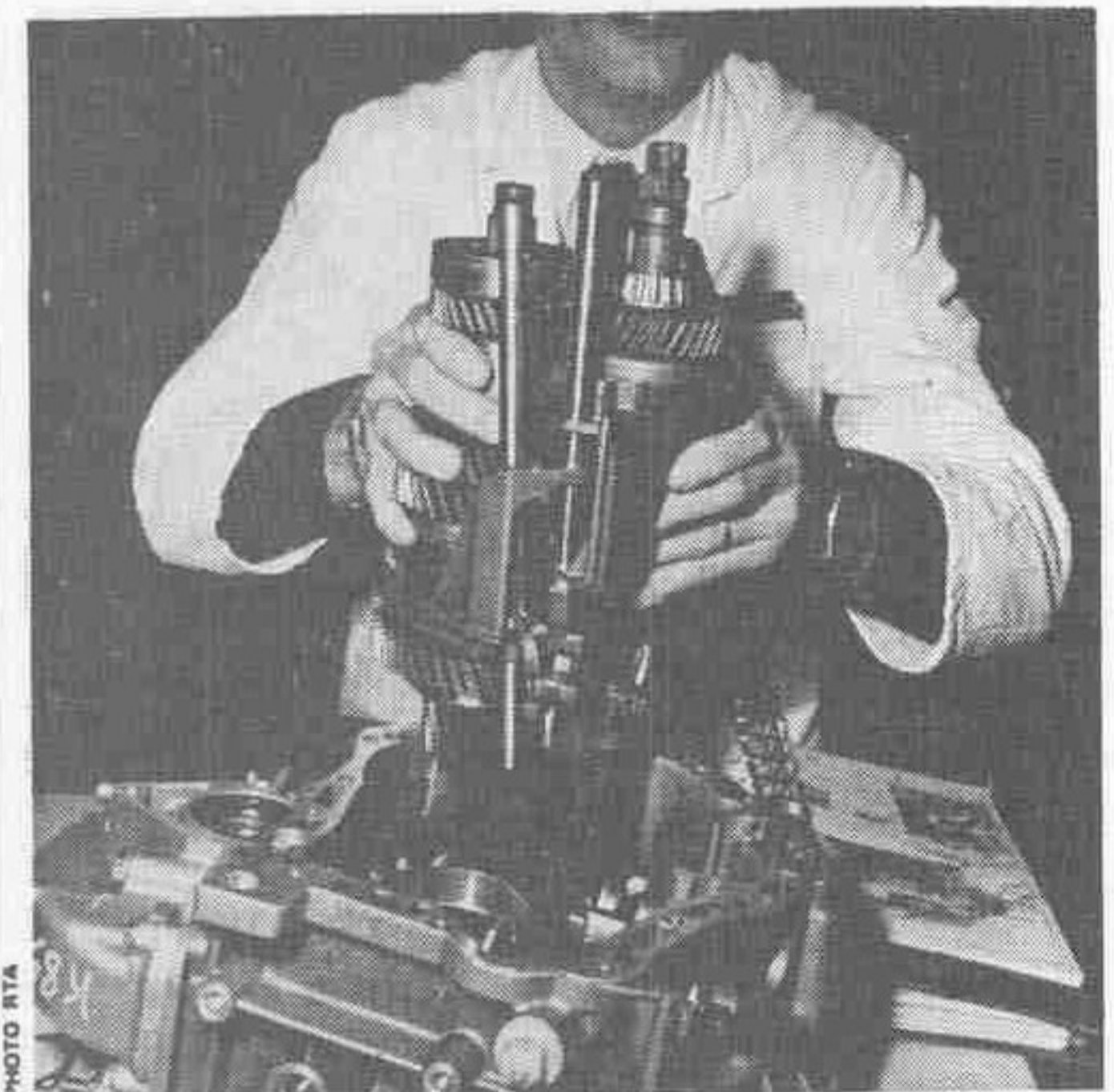
Mise en place, ensemble, des arbres primaire, secondaire avec les fourchettes
