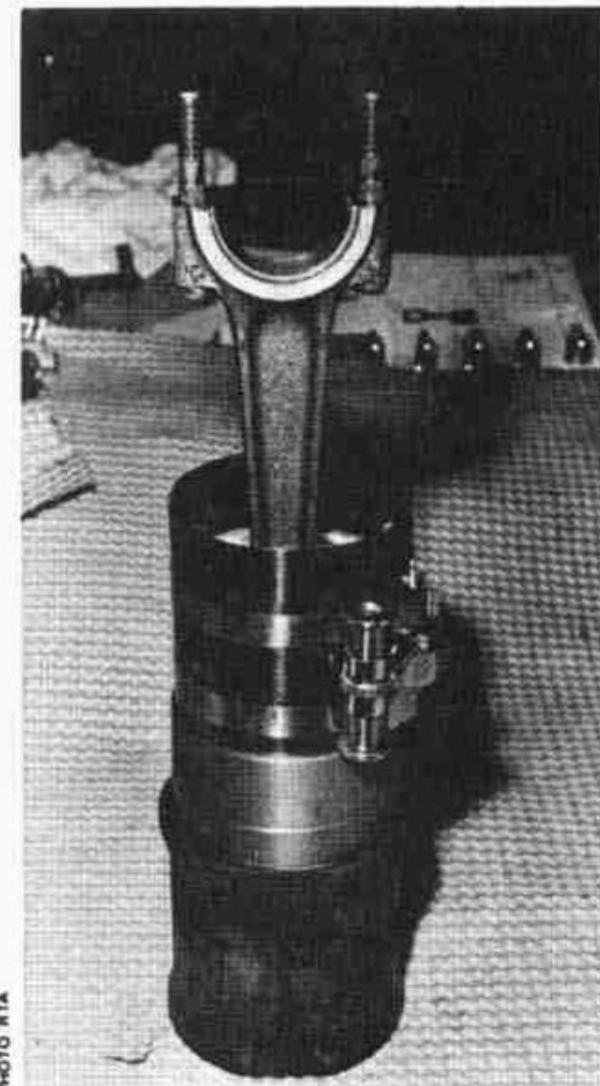
Montage chemise-piston à l'aide d'un collier à segments
