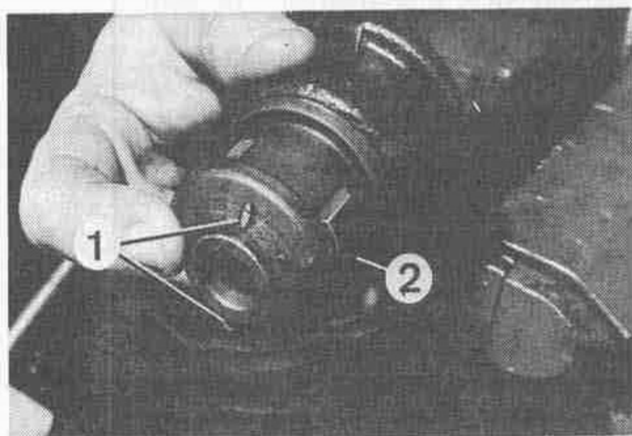
Orientation du silentbloc arrière de bras inférieur avant 1. Ergots - 2. Renfort
