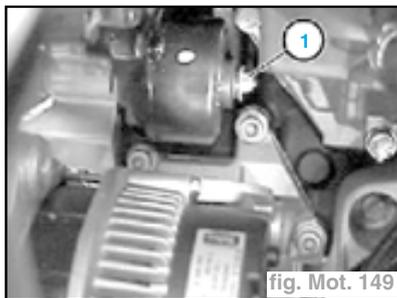
**Nota :** Remplacer l'écrou lors de sa repose.
