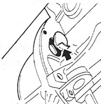
Dépose de la transmission automatique Flèche : cache de l'orifice pour la dépose des vis de fixation du convertisseur de couple.
