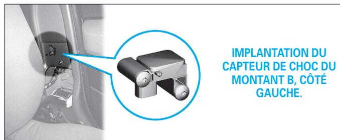
Les accéléromètres mesurent aussi bien une accélération qu'une décélération (la décélération caractérise un choc frontal, l'accélération caractérise un choc arrière). Le côté du choc est détecté par la polarité des valeurs des capteurs d'accélération.
