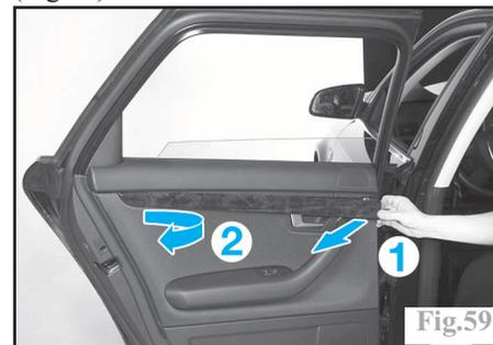
Déposer les 2 vis de fixation de la poignée de retenue (Fig.60). Déposer les vis de fixation (1) (Fig.61). Décliper fermement la garniture aux endroits indiqués (2). Déposer la manivelle de lève-vitre (selon équipement). Déposer la garniture vers le haut, afin de la désolidariser du joint intérieur de porte.
