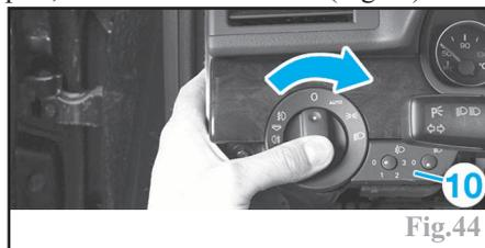
Déposer le dispositif de réglage des phares (10).
