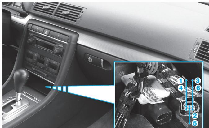
**CAPTEUR DE PRESSION DE FREINAGE**
