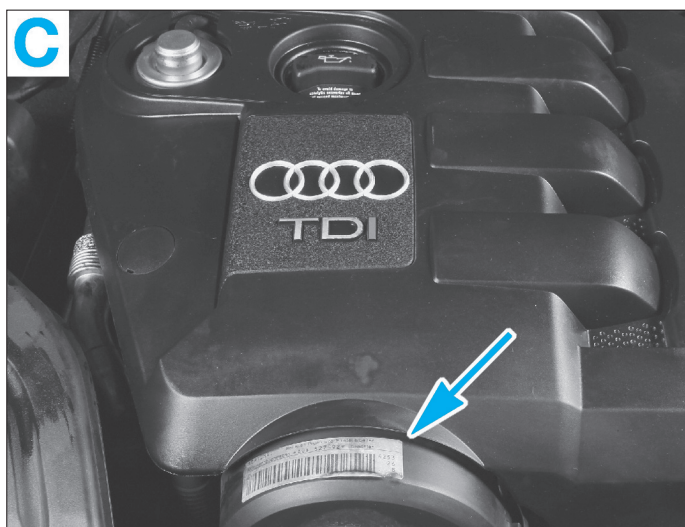
Implantation de l'étiquette de rappel de l'identification moteur (C)
