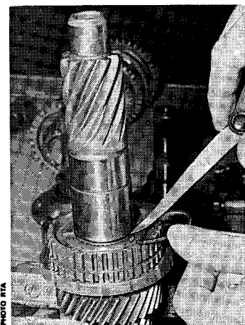
Mesure de l'épaisseur de l'anneau d'ar- rêt à monter : additionner la valeur de la cale à l'épaisseur de l'anneau pour obtenir l'épaisseur maxi possible, monter un anneau de la taille juste inférieure
