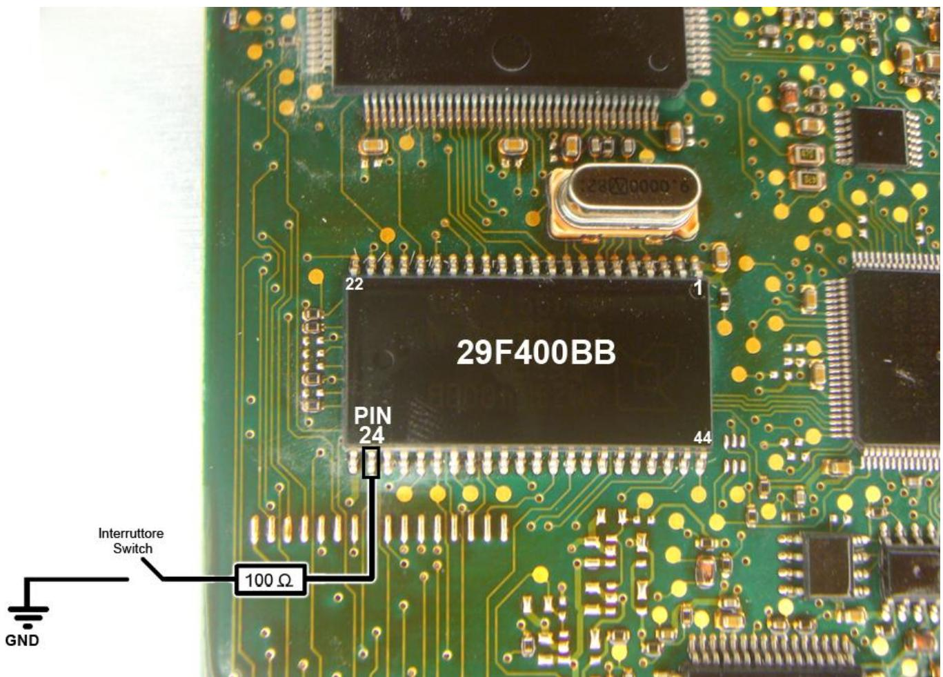
Eseguire il collegamento del pin out come da figura sotto per euro 4/5 29F400BB.
