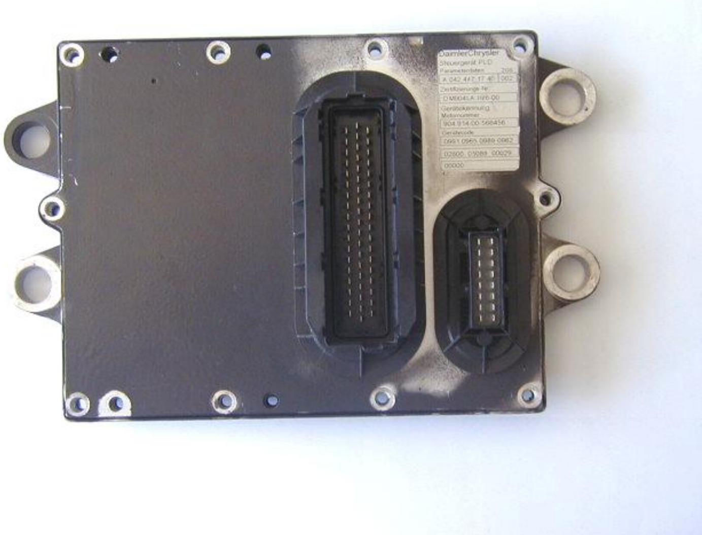
Smontare la Ecu dal camion , svitare le viti, ed alzare il coperchio molto lentamente senza danneggiarlo.
