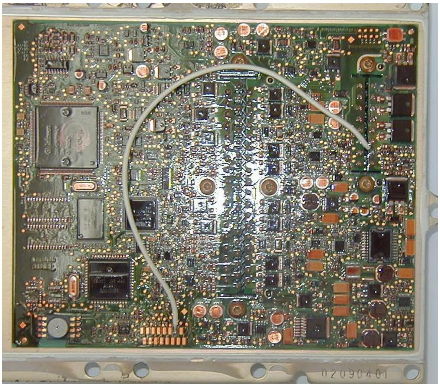
Se si vuole lasciare il filo e chiudere la centralina, usare un cavo al silicone resistente alle alte temperature almeno fino a 100C°.
