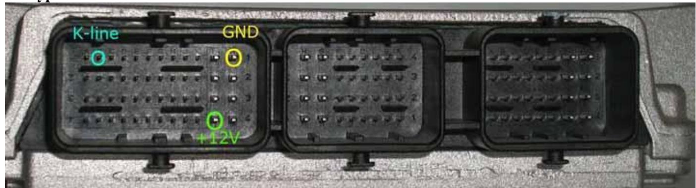
Alimentare la centralina seguendo le indicazioni sopra riportate in base al tipo di connettore A o B.
