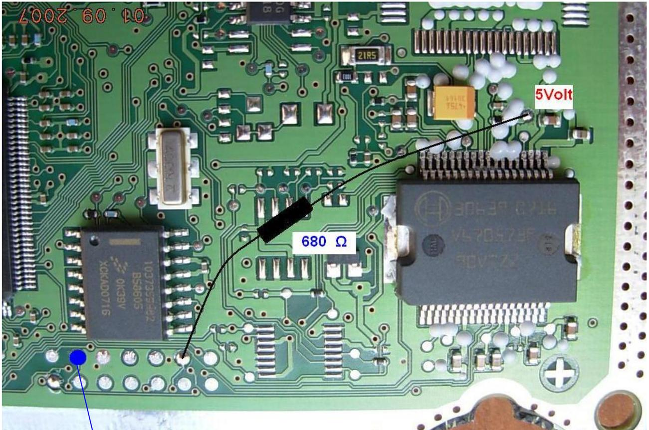
Questo è il pin di Bootstrap , connetterlo alla banana Blu del serial suite tramite l'apposito cavo , e il puntale in dotazione. Tenendo connesso il puntale per un paio di secondi , durante la fase di connessione si abilita la modalità di lettura e scrittura della centralina.
