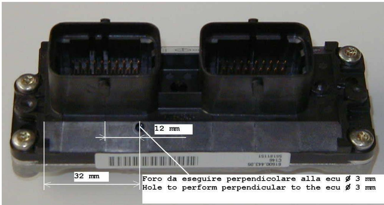
Eseguire un foro del diametro di 3 mm perpendicolare alla centralina con le misure del disegno sopra.
