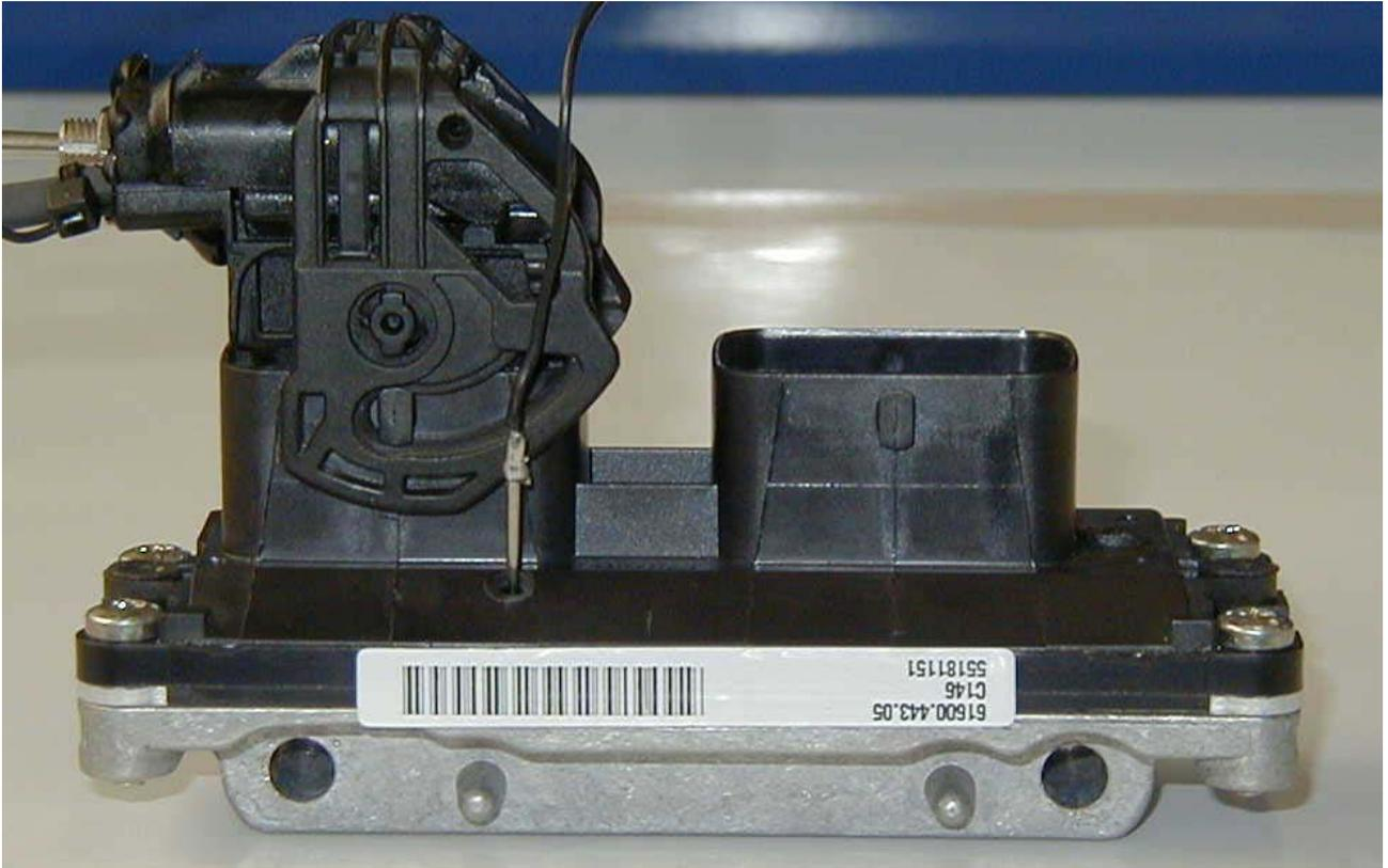
Dopo aver eseguito il foro montare il connettore , infilare perpendicolarmente un ago con la massa che andrà a toccare il piedino della scheda per il bootstrap ed alimentare la centralina. Se tutto è corretto ora centralina è in bootstrap.
